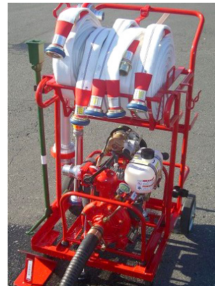
軽可搬消火ポンプ
